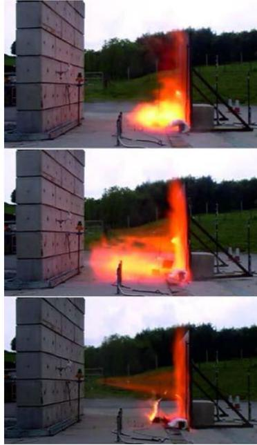
Figure 20. Inflammation retardée (0,8 s) du jet d'hydrogène (pression de stockage de 20,5 MPa, diamètre de buse de 9,5 mm) heurtant une barrière à 90° : stade de déflagration (capture du haut et du milieu), stade du jet enflammé stable heurtant la barrière (capture du bas), test HSL [38].
