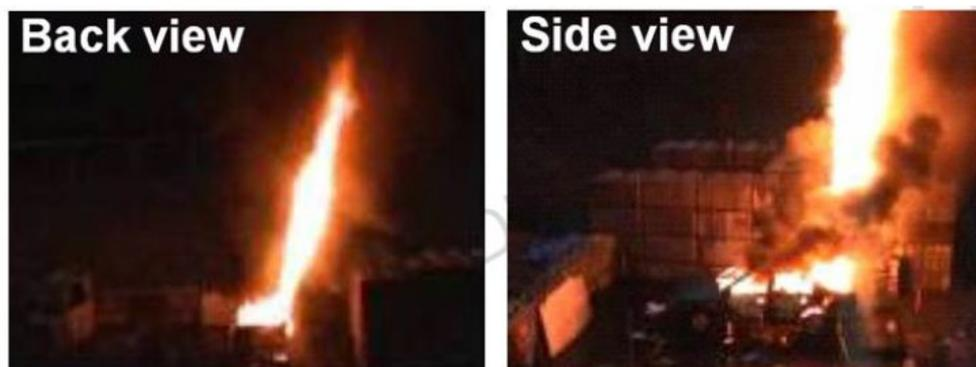
Figure 32. Flamme-jet d'hydrogène issue d'un DD d'un VPC orientée vers le haut [48]. (NOTE current TPRDs tend to be angled)
