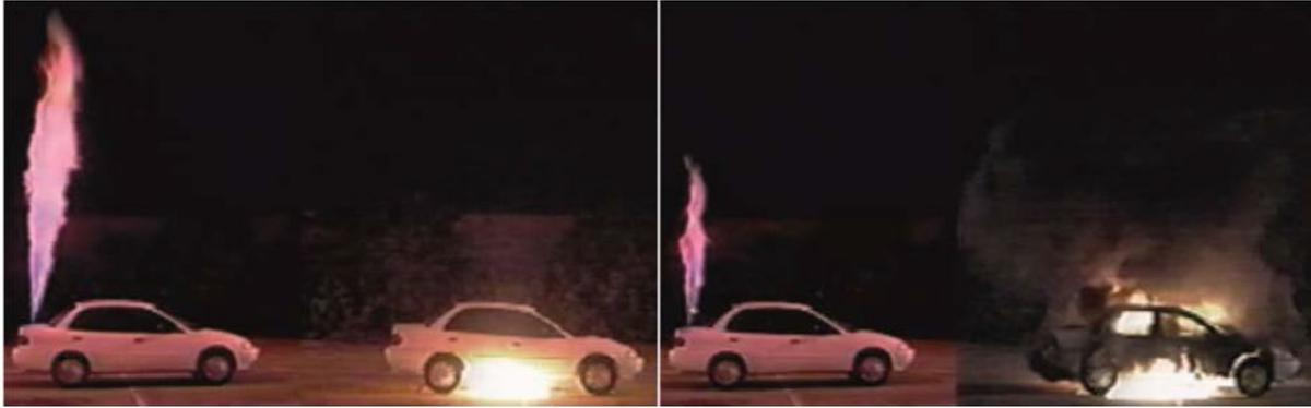
Figure 29. Jet enflammé d'hydrogène et incendie d'essence : 3 s (gauche) et 60 s (droite) après le début d'un incendie de véhicule [45].
