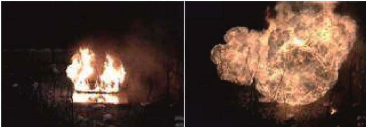
Figure 30. Test d'incendie de nappe d'essence d'un VPC : gauche – incendie d'essence juste avant le démarrage du DDT, droite – 1 seconde après le démarrage du DDT [46].
