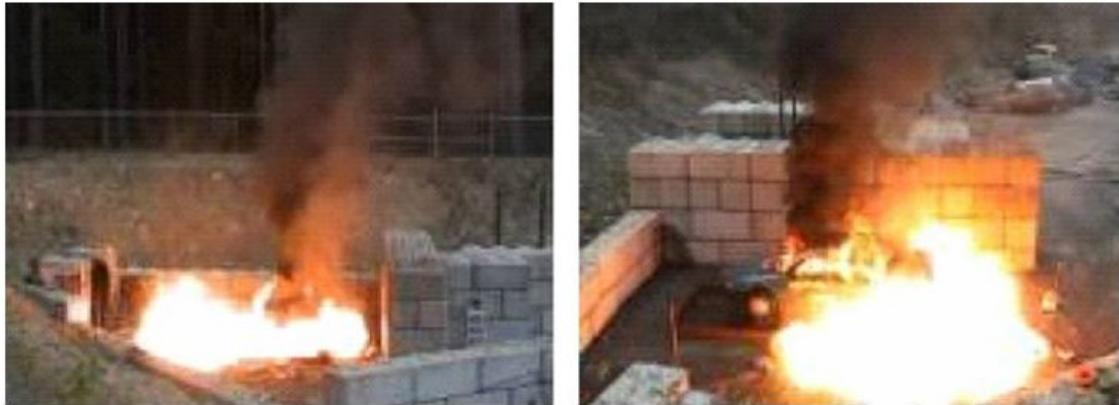
Figure 33. Flamme-jet d'hydrogène issue d'un DD d'un VPC orienté vers le bas (gauche - vue de dos du véhicule ; droite - vue latérale du véhicule [48].
