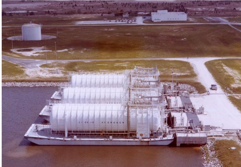
Figure 34. Flotte de barges d'hydrogène liquide de la NASA. (Sources : NASA)
