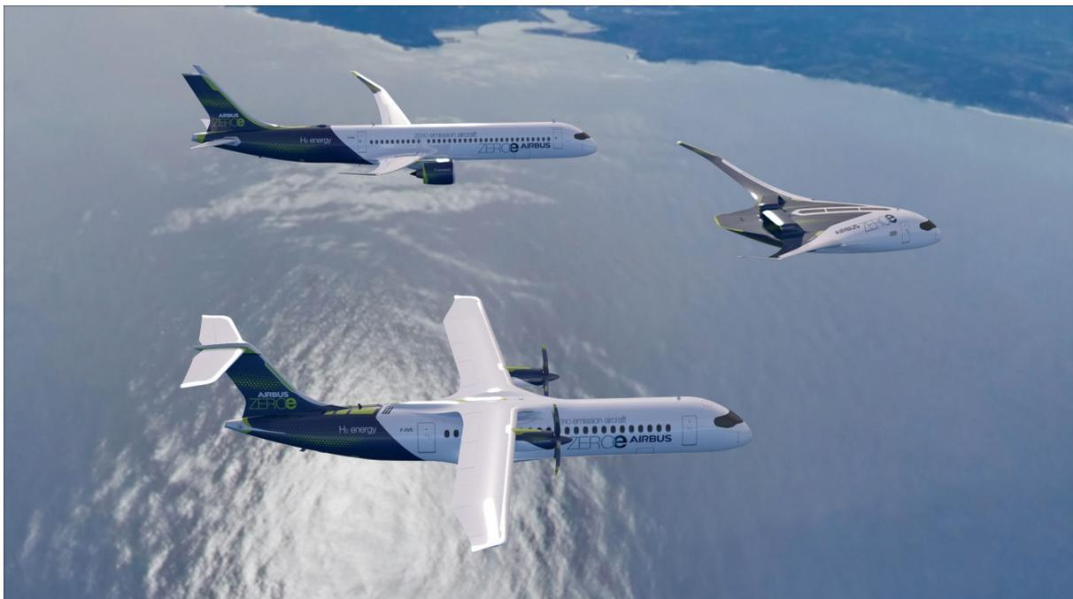
Figure 53 Avions conceptuels ZEROe d'Airbus. De haut en bas : turboréacteur à double flux, « avion à aile volante » et turbopropulseur.
