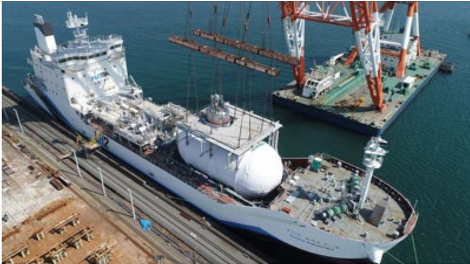
Figure 35. Le SUISEO FRONTIER, le premier navire transporteur de LH<sub>2</sub> au monde lancé en 2019 et doté d'un réservoir de stockage de LH<sub>2</sub> [75].
