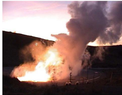
Figure 7. Libération à grande échelle de LH<sub>2</sub> et inflammation retardée (5 bar - 12 mm ; projet PRESLEY - HSE).
