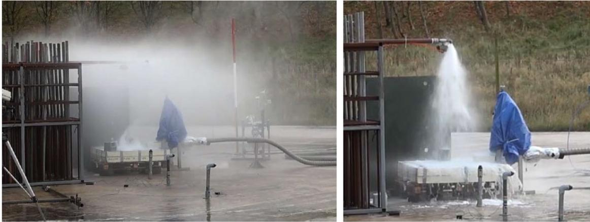
Figure 9. Installation expérimentale pour l'étude de la transition de phase rapide. À gauche : pulvérisation d'eau globale provenant d'arroseurs. À droite : application d'un jet d'eau au centre du bac (à droite).
