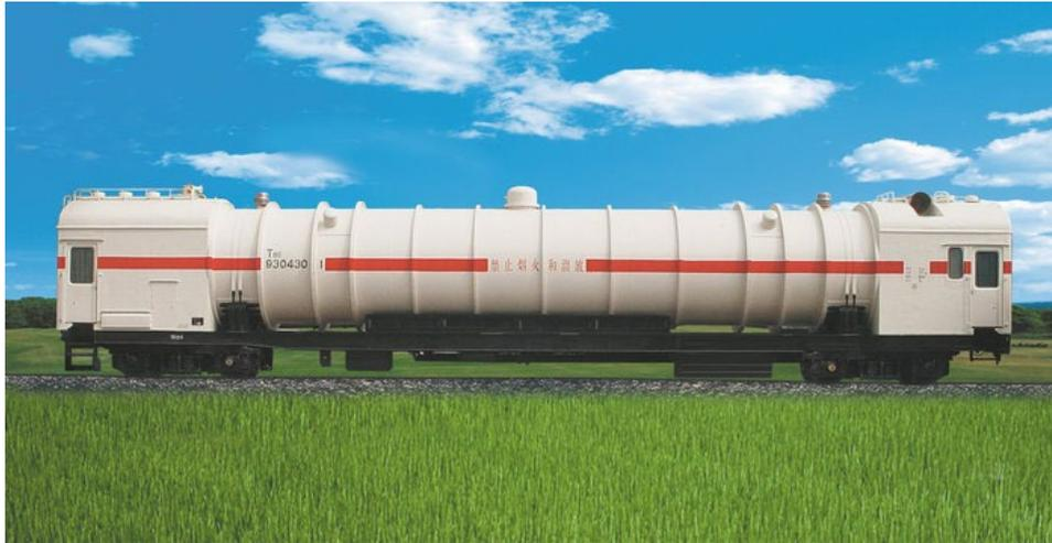
Figure 37. Wagon-citerne d'hydrogène liquide de type T85 [80].
