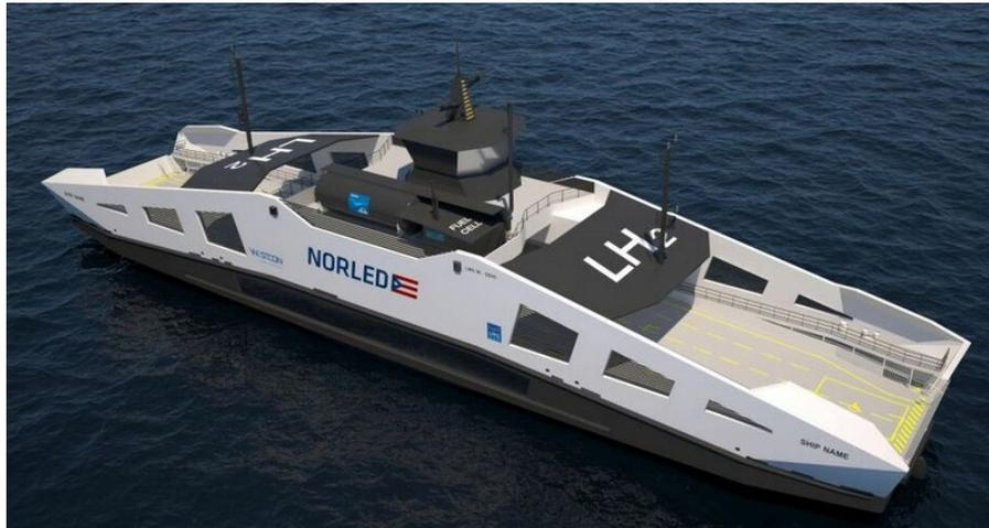
Figure 48. Disposition du réservoir de stockage de LH<sub>2</sub>, de la pile à combustible et du mât de ventilation sur le pont du ferry NORLED [85].
