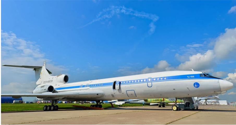
Figure 51. « Laboratoire volant » Tupolev 155 de 1988 doté d'un moteur central alimenté en LH<sub>2</sub> ou en GNL [91].
