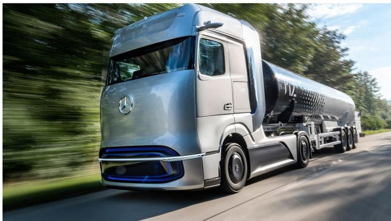
Figure 46. Concept de camion à pile à combustible Mercedes GenH2 doté d'un réservoir de stockage de LH<sub>2</sub>.
