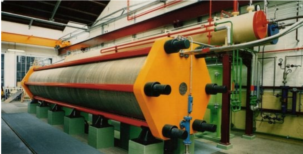
Figure 5. Électrolyseur alcalin IHT type S-556, 760 m 3 /h et 30 bar [1]
