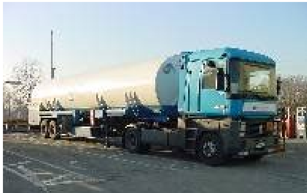
Figure 21. Un camion-citerne exploité par Air Liquide pour transporter le LH 2 jusqu'à l'utilisateur final.
