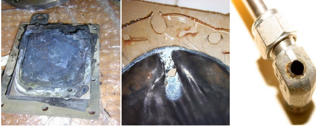
Figure 30. Pièces endommagées de l'électrolyseur à membrane échangeuse de protons haute pression
