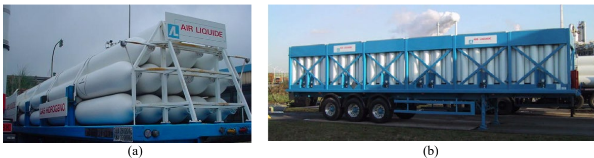
Figure 19. Deux types de remorques de CGH 2 exploitées par AirLiquide en Europe : (a) remorque à tubes transportant 2 000 à 3 000 Nm 3 d'hydrogène et (b) remorque à cylindres composites transportant 6 200 Nm 3 d'hydrogène.
