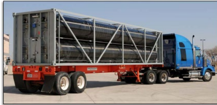
Figure 20. Remorque transportant quatre réservoirs composites élaborés par Lincoln Composites.
