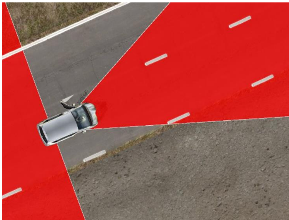
Figure 43 : (en rouge) Angles interdits pour atteindre un véhicule à PCH dont les roues sont en feu. ©Crise-2015
