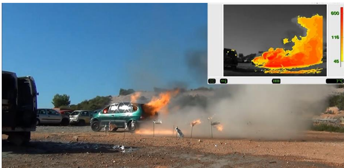
Figure 8 : Incendie d'un réservoir d'hydrogène (700b) (ENSOSP 2014).
