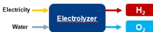
Figure 15 : Principe de l'électrolyseur
