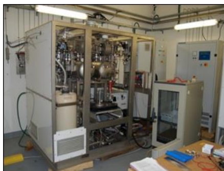
Figure 17 : Caractéristiques techniques et photo de la pile à combustible MEP de stockage d'énergie AREVA New Stack
