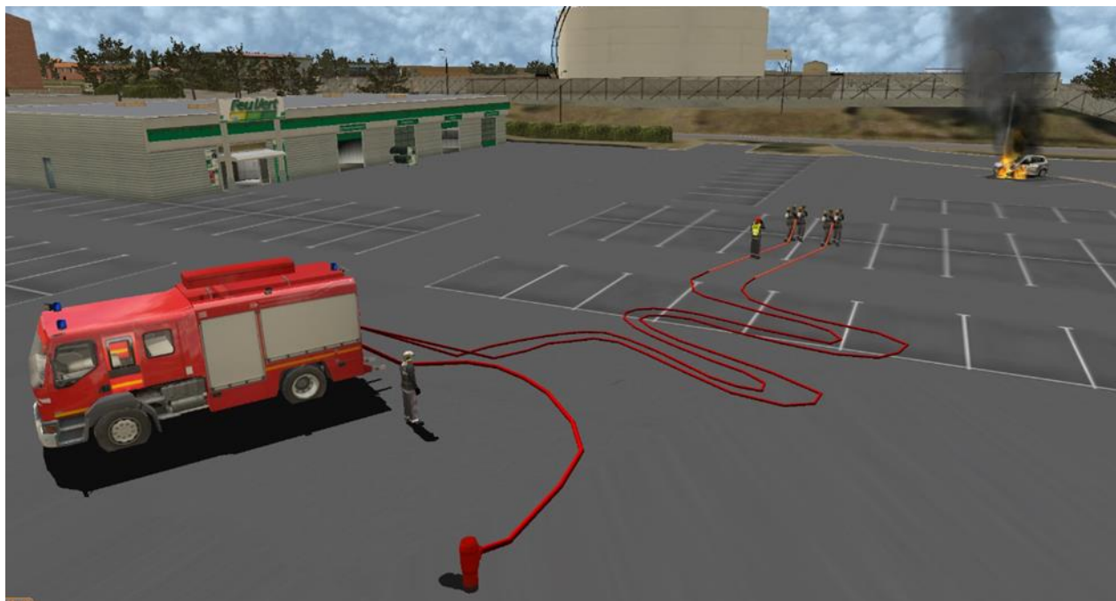
Figure 42 : Préparation à une attaque d'incendie offensive (se raccorder à une bouche d'incendie si
