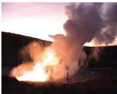
Figure 7 : Libération de LH 2 (enflammée) - Source : Banque d'images Air Liquide
