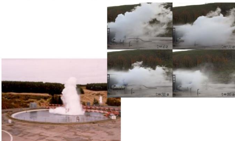
Figure 5 : Représentation de la Transition de Phase rapide Source : Banque d'images Air Liquide
