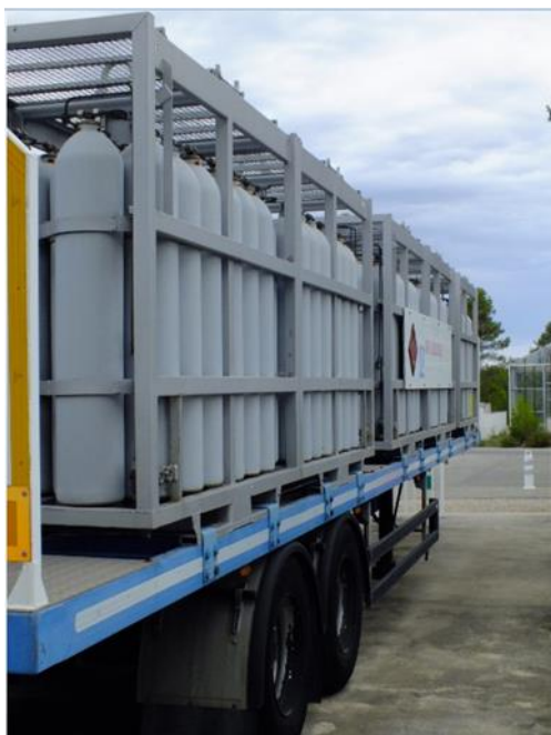
Figure 54 : Remorque de H2 avec des porte-bouteilles verticaux. © Areva/ENSOSP 2015
