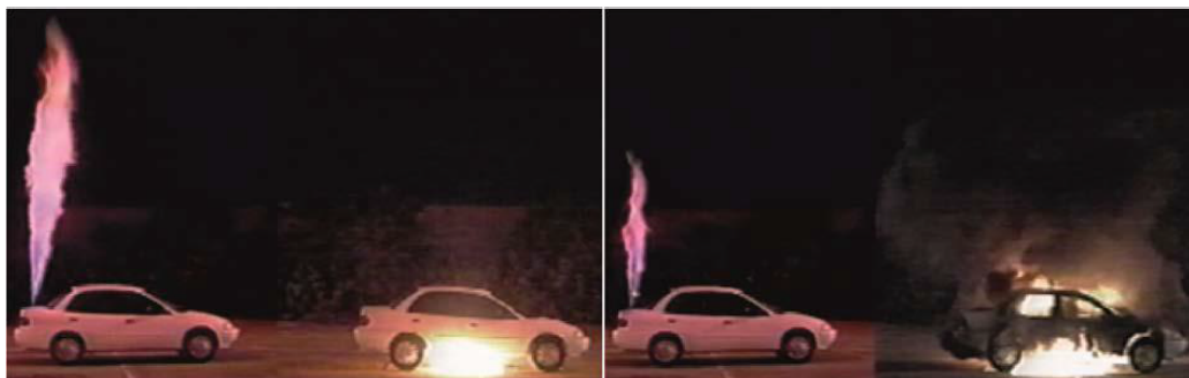
Figura 3. Incendio de chorro de hidrógeno e incendio de gasolina: 3 seg (izquierda) y 60 seg (derecha) después del inicio del incendio de un coche [13].
