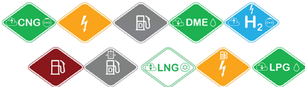
Figura 2. Colores y símbolos sugeridos por el CTIF para el desarrollo de señales estandarizadas
