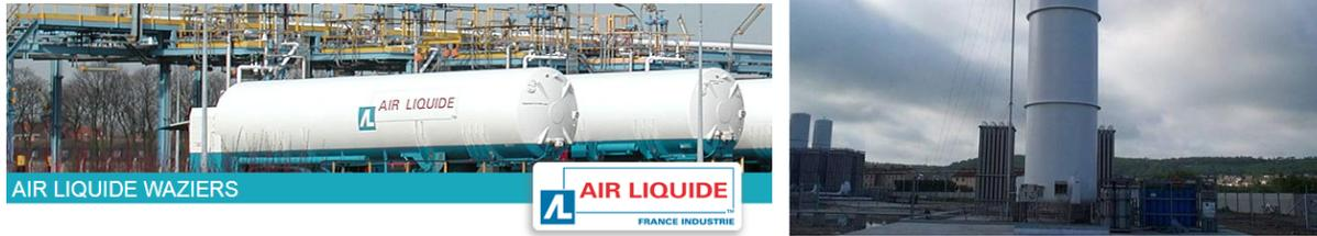
Figura 3. Depósitos de hidrógeno líquido verticales u horizontales. (Fuente Air Liquide).
