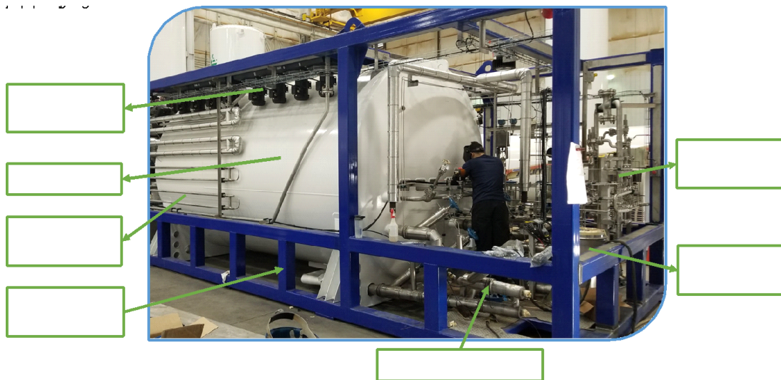
Figura 13. Visión general del patín LHRS - lado "criogénico".
