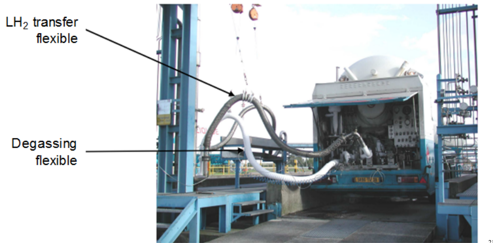
Figura 38 Remolque de \text{HL}_2 durante la transferencia.
