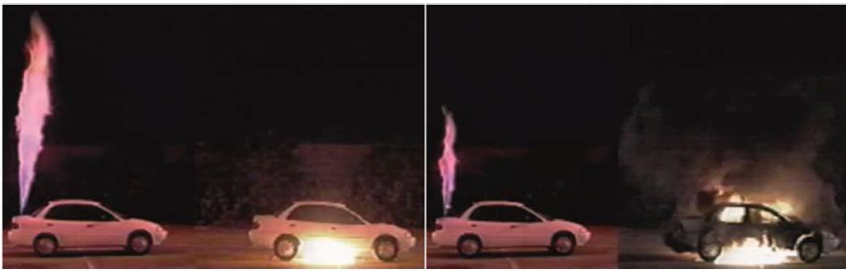
Figura 3. Jet fire d'idrogeno ed incendio di benzina: 3 s (sinistra) e 60 s (destra) dopo l'iniziazione dell'incendio del veicolo [13].
