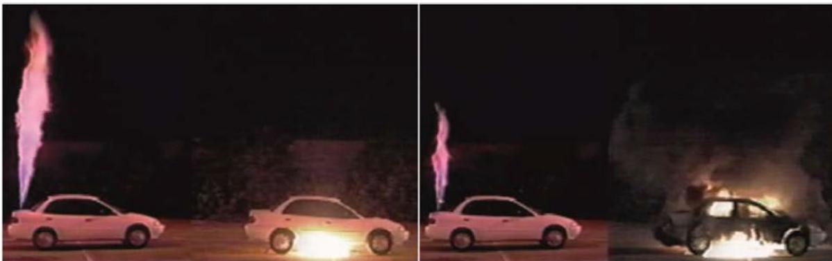
Abbildung 29. Wasserstoffstrahlfeuer und Benzinfeuer: 3 s (links) und 60 s (rechts) nach Auslösung eines Autobrandes [45].
