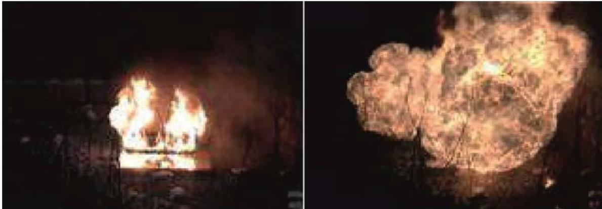
Abbildung 30. Ein FCV-Benzinpool-Brandtest: links - Benzinbrand kurz vor Auslösung des TPRD, rechts - 1 Sekunde nach Auslösung des TPRD [46].
