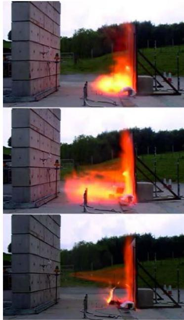
Abbildung 20. Die verzögerte (0,8 s) Zündung eines Wasserstoffstrahls (20,5 MPa Druckspeicher, Düse mit 9,5 mm Durchmesser), der auf eine 90er-Barrier auftrifft<sup>o</sup>: Deflagrationsphase (oberer und mittlerer Schnappschuss), stationäre Feuerphase des auftreffenden Strahls (unterer Schnappschuss), HSL-Test [38].
