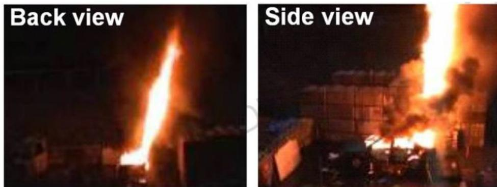
Abbildung 32. Wasserstoffstrahlflamme aus einem nach oben gerichteten PRD eines FCV [48].
