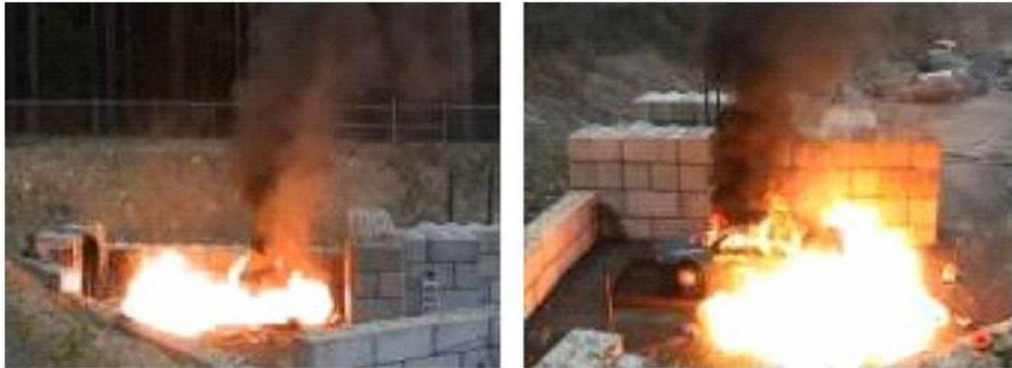
Abbildung 33. Wasserstoffstrahlflamme aus einer nach unten gerichteten PRD eines FCV (links - Rückansicht des Fahrzeugs; rechts - Seitenansicht des Fahrzeugs) [48].
