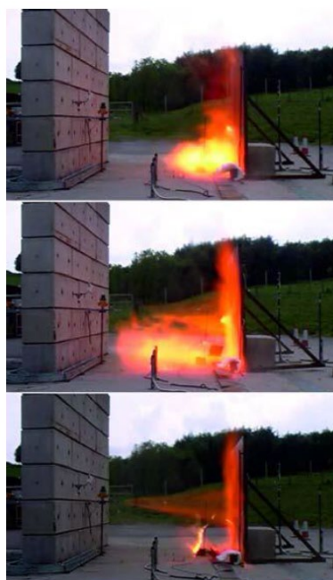
Obrázek 20. Opožděné (0,8 s) zapálení vodíkového proudu (skladovací tlak 20,5 MPa, tryska s průměrem 9,5 mm) narážejícího na 90° konstrukci: fáze deflagrace (horní a prostřední snímek), fáze ustáleného tryskového požáru (spodní snímek), zkouška HSL [38].
