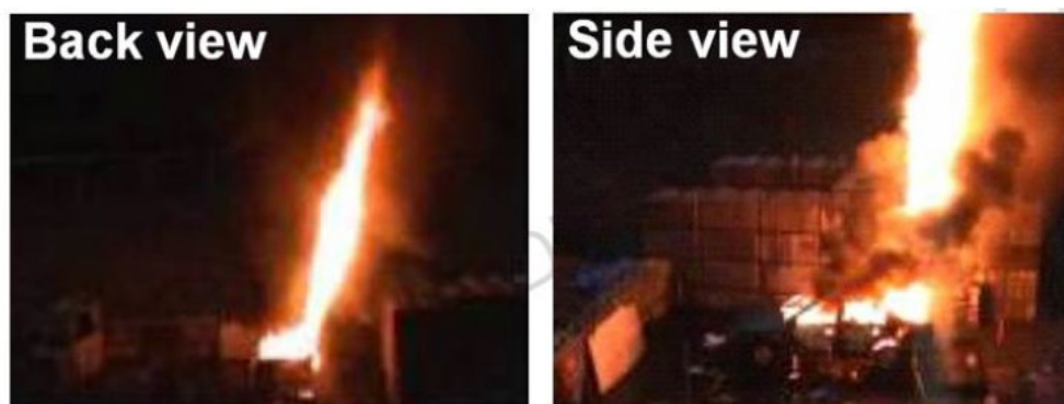
Obrázek 32. Vodíkový tryskový požár ze zařízení PRD orientovaného vzhůru ve vozidle s palivovými články [48]. (POZNÁMKA: současná zařízení TPRD mívají zpravidla šikmý vývod)
