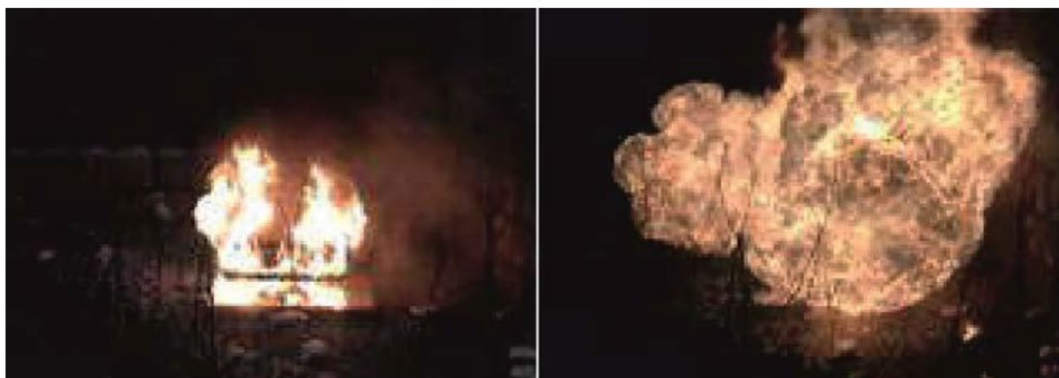
Obrázek 30. Zkouška požáru FCV od benzinové kaluže: vlevo – požár benzinu těsně před aktivací zařízení TPRD, vpravo – 1 sekundu po aktivaci zařízení TPRD [46].
