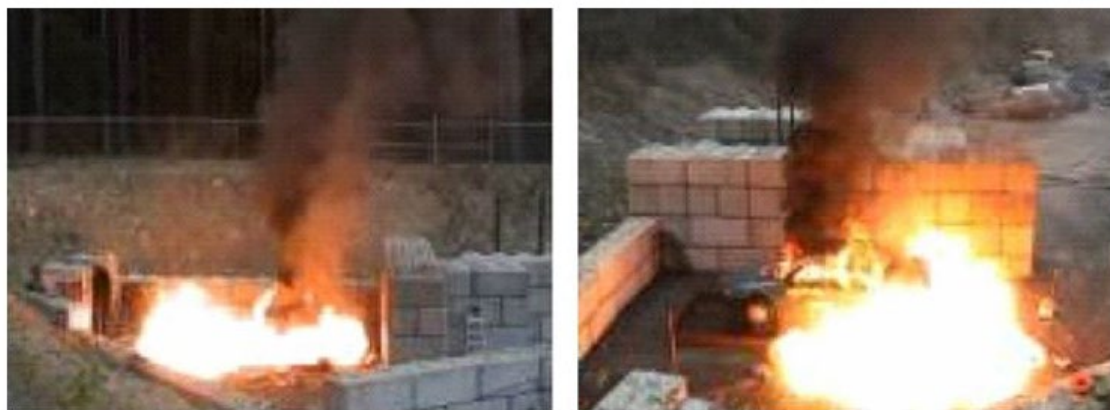
Obrázek 33. Vodíkový tryskový požár ze zařízení PRD nasměrovaného dolů ve vozidle s FC (vlevo – pohled zezadu vozidla; vpravo – pohled z boku vozidla) [48].
