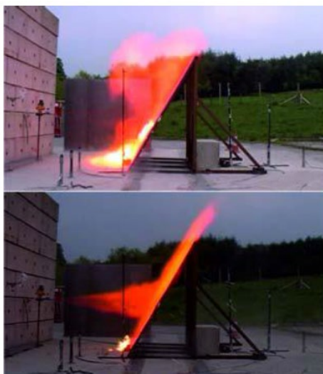
Obrázek 21. Opožděné (0,8 s) zapálení vodíkového proudu (skladovací tlak 20,5 MPa, tryska s průměrem 9,5 mm) narážejícího na 60° konstrukci: fáze deflagrace (horní snímek), fáze ustáleného tryskového požáru (spodní snímek), zkouška HSL [38].
