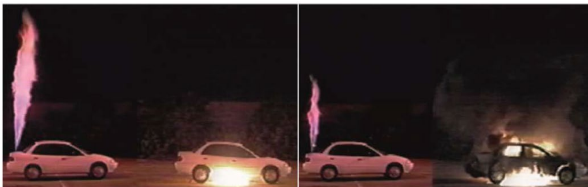
Obrázek 29. Tryskový požár vodíku a požár benzínu: 3 s (vlevo) a 60 s (vpravo) po iniciaci požáru vozidla [45].
