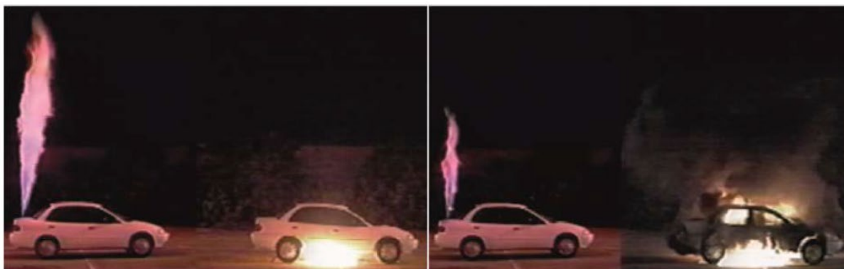
Abbildung 3. Wasserstoffstrahlfeuer und Benzinfeuer: 3 s (links) und 60 s (rechts) nach Auslösung eines Autobrandes [15].
