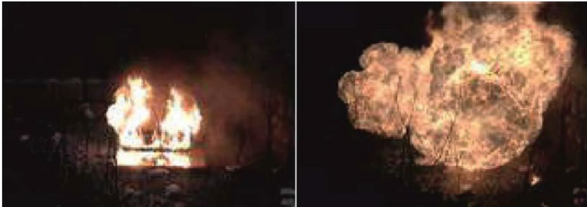
Abbildung 4. Ein FCV-Benzinpool-Brandtest: links - Benzinbrand kurz vor Auslösung des TPRD, rechts - 1 Sekunde nach Auslösung des TPRD [16].
