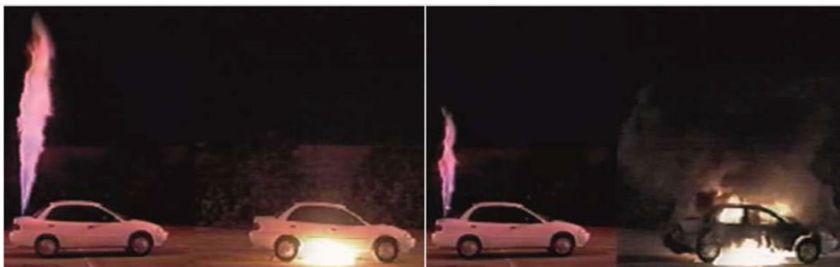
Obrázek 3. Tryskový požár vodíku a požár benzínu: 3 s (vlevo) a 60 s (vpravo) po iniciaci požáru vozidla [15].
