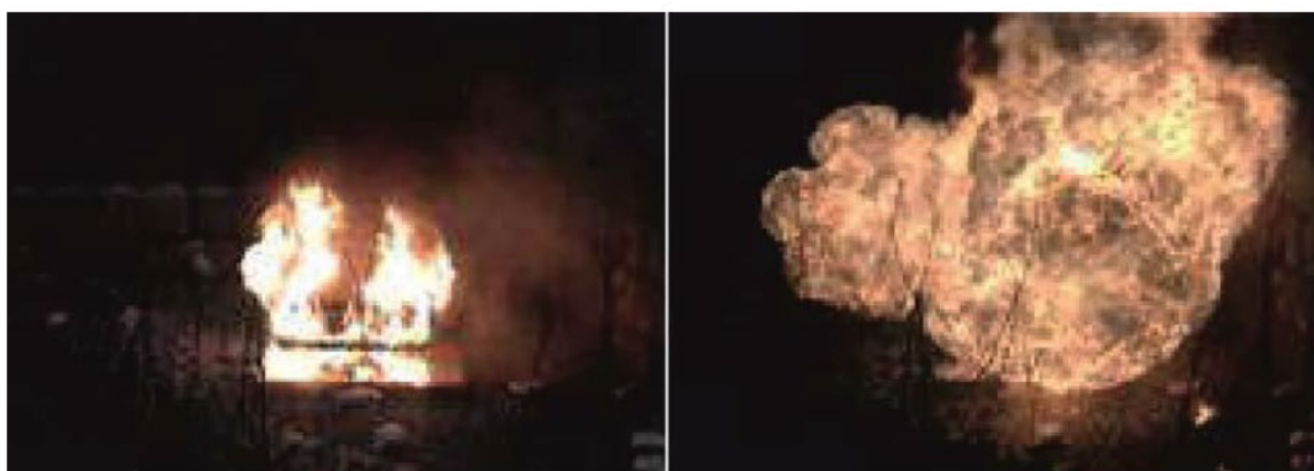
Obrázek 4. Zkouška požáru FCV od benzinové kaluže: vlevo – požár benzínu těsně před aktivací zařízení TPRD, vpravo – 1 sekundu po aktivaci zařízení TPRD [16].
