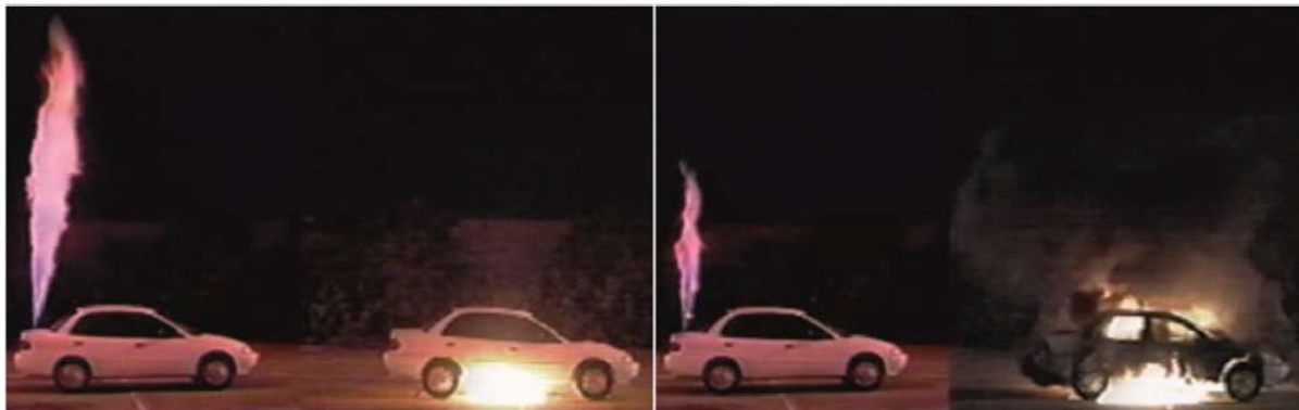
Abbildung 3. Wasserstoffstrahlfeuer und Benzinfeuer: 3 s (links) und 60 s (rechts) nach Auslösung eines Autobrands [15].
