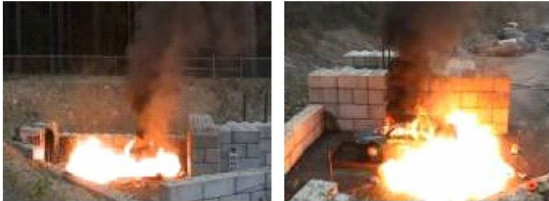
Abbildung 7. Wasserstoffstrahlflamme aus einer nach unten gerichteten PRD eines FCV (links - Rückansicht des Fahrzeugs; rechts - Seitenansicht des Fahrzeugs) [18].
