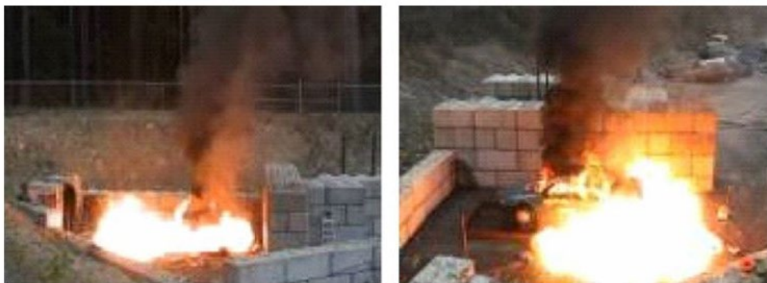
Obrázek 7. Vodíkový tryskový požár ze zařízení PRD nasměrovaného dolů ve vozidle s FC (vlevo – pohled zezadu vozidla; vpravo – pohled z boku vozidla) [18].
