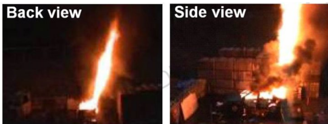
Obrázek 6. Vodíkový tryskový požár ze zařízení PRD orientovaného vzhůru ve vozidle s palivovými články [18]. (POZNÁMKA: současná zařízení TPRD mívají zpravidla šikmý vývod)
