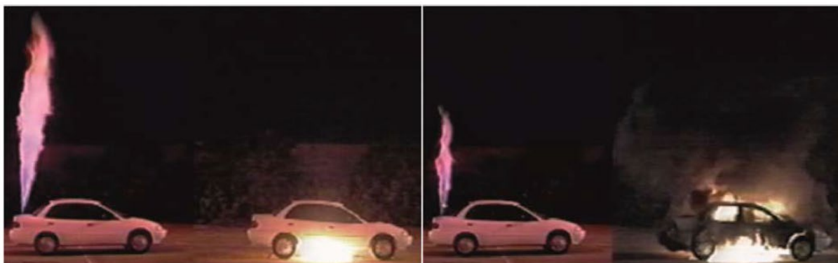
Abbildung 3. Wasserstoffstrahlfeuer und Benzinfeuer: 3 s (links) und 60 s (rechts) nach Auslösung eines Autobrandes [13].
