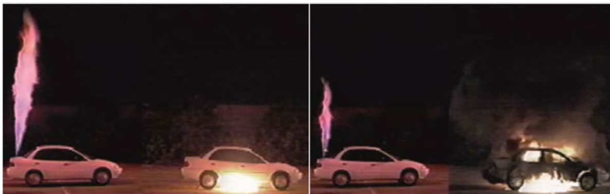
Obrázek 3. Tryskový požár vodíku a požár benzínu: 3 s (vlevo) a 60 s (vpravo) po iniciaci požáru vozidla [13].
