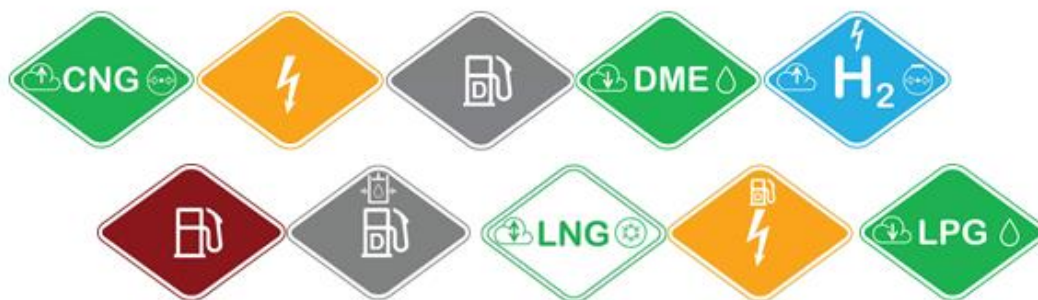
Figura 2. Colori e simboli suggeriti dal CTIF per lo sviluppo di simboli standardizzati. Grigio: diesel; Rosso: benzina; Verde: gas; Azzurro: idrogeno; Arancione: alto voltaggio. Simboli: 1) Prima fonte di energia; 2) Seconda fonte di energia; 3) Densità relativa all'aria; 4) Stato di aggregazione nello stoccaggio.
