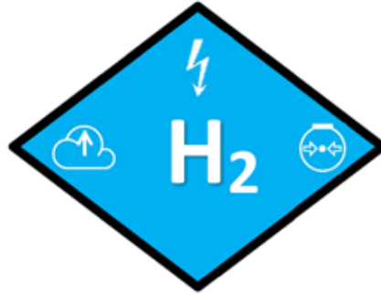
Figura 4. Un simbolo sviluppato dal CTIF per i veicoli FC alimentati da idrogeno gas compresso [15].
