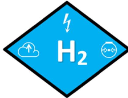
Abbildung 4. Ein vom CTIF entwickeltes Symbol für ein mit komprimiertem gasförmigem Wasserstoff betriebenes BZ-Fahrzeug [15]
