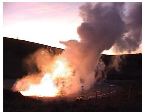
Figura 2. Rilascio su larga scala di LH<sub>2</sub> e accensione ritardata (5 bar - 12 mm; progetto PRESLHY - HSE).
