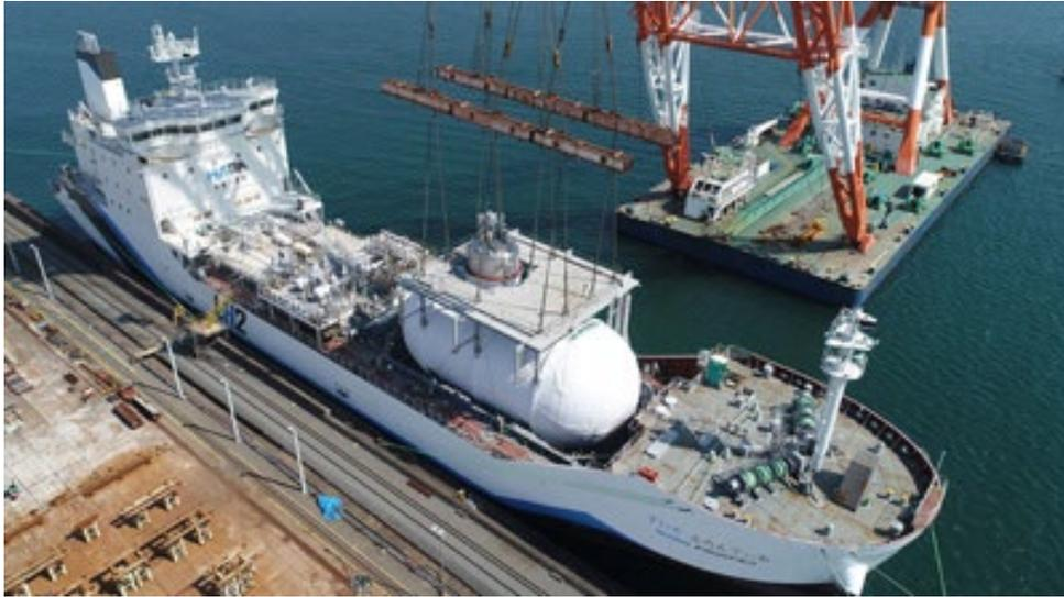
Abbildung 35. SUIISO FRONTIER, das erste LH<sub>2</sub>-Transportschiff der Welt, das 2019 vom Stapel läuft, mit LH<sub>2</sub>-Speichertank [75].
