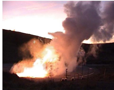
Abbildung 7. LH<sub>2</sub>-Großauslösung und verzögerte Zündung (5 bar - 12 mm; Projekt PRESLHY - HSE).
