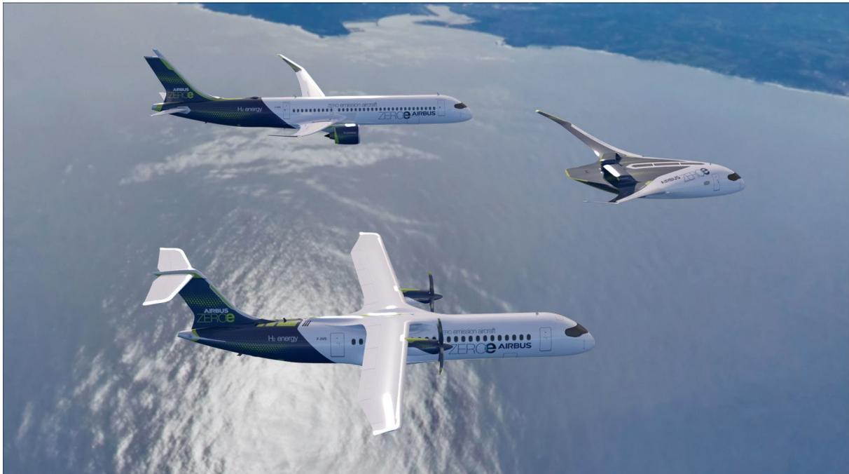
Abbildung 53 Airbus ZEROe-Konzeptflugzeuge. Turbofan-, Blended-Wing-Body- und Turboprop-Konzepte von oben nach unten.
