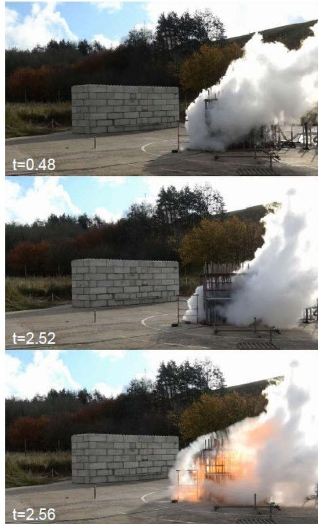
Abbildung 21. Bilder, die plötzliche Böen unmittelbar vor der Zündung für den Test mit Auslösung zeigen:  $p = 1$  bar,  $d = 12$  mm und Windgeschwindigkeit = 2m/s.
