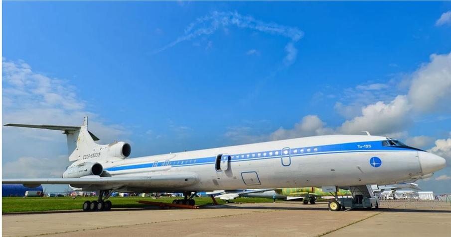
Abbildung 51. Tupolev 155 "Fliegendes Labor" von 1988 mit dem zentralen Triebwerk das mit  $\text{LH}_2$  oder LNG betrieben wird [91].
