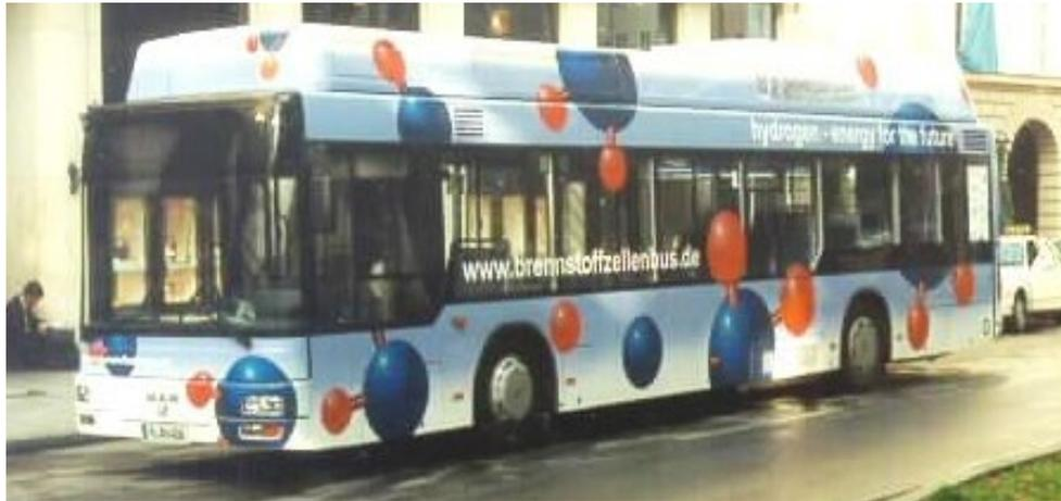
Abbildung 44. Wasserstoffbetriebener MAN-Brennstoffzellenbus von 1996 mit LH-Speichern<sub>2</sub>
