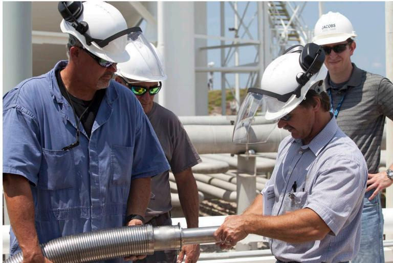
Abbildung 31. LH<sub>2</sub>-Versorgungsschlauchs im Kennedy Space Centre der NASA (Bildnachweis: NASA/Frankie Martin).
