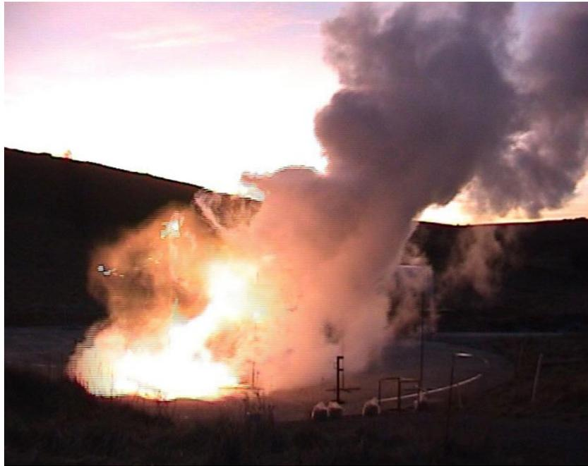
Abbildung 14. LH<sub>2</sub> Dampf Wolke bei schwachen Windverhältnissen (keine sekundäre Explosion).
