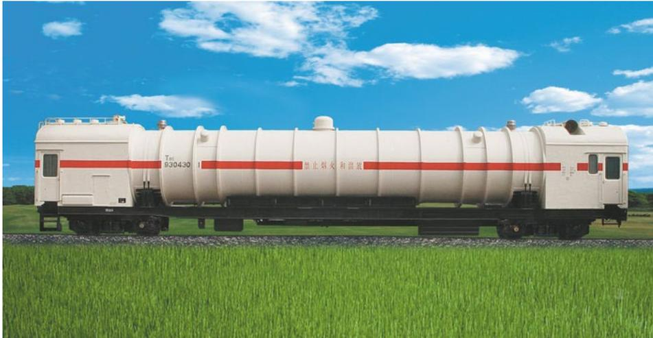
Abbildung 37. Kesselwagen für Flüssigwasserstoff des Typs T85 [80].
