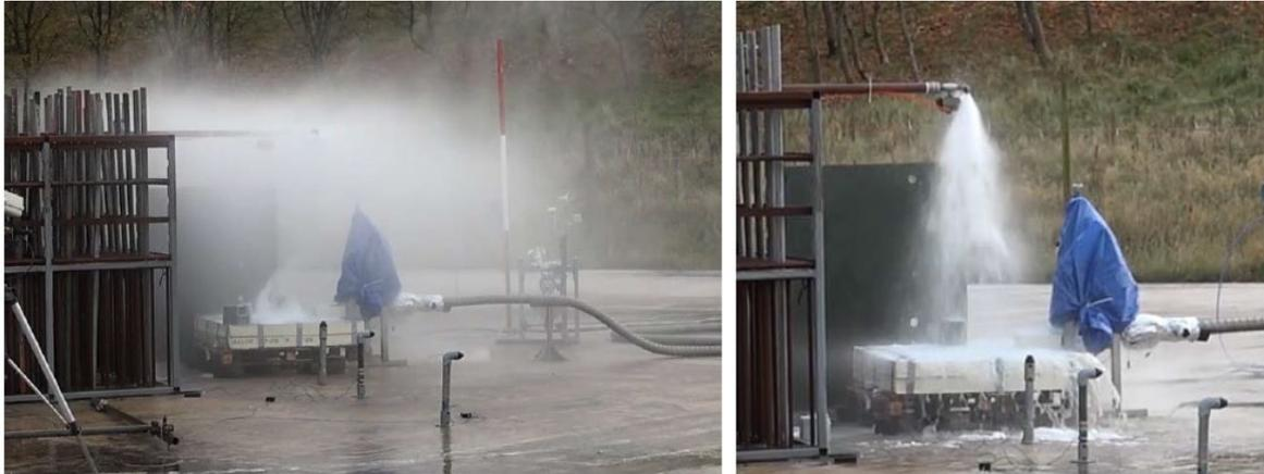
Abbildung 9. Versuchsanlage zur Untersuchung des schnellen Phasenübergangs. Links: voll entwickelter Wasserstrahl aus Sprinklern. Rechts: Wasserstrahl in der Mitte der Schale (rechts).
