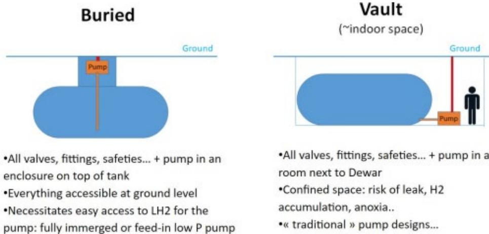
Abbildung 25. Die beiden wichtigsten möglichen Konzepte für unterirdische LH<sub>2</sub>-Speicher.
