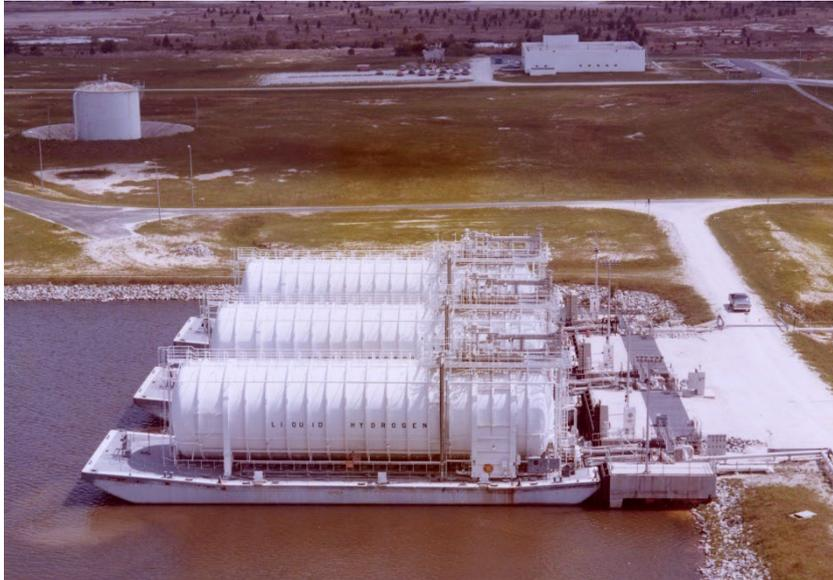
Abbildung 34. Flotte der NASA-Flüssigwasserstoffkähne. (Quellen: NASA)
