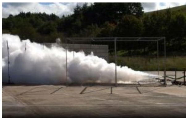
Obrázek 2. Rozsáhlé uvolňování a zpožděné zapálení LH 2 (5 bar – 12 mm; projekt PRESLHY – HSE).
