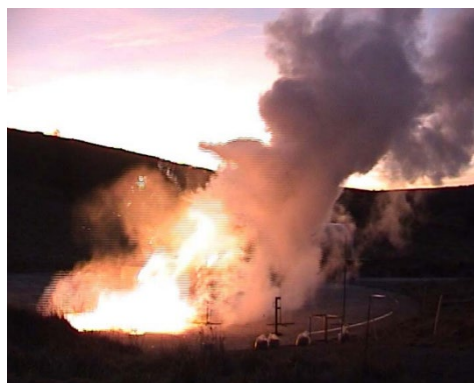
Obrázek 2. Rozsáhlé uvolňování a zpožděné zapálení LH 2 (5 bar – 12 mm; projekt PRESLHY – HSE).
