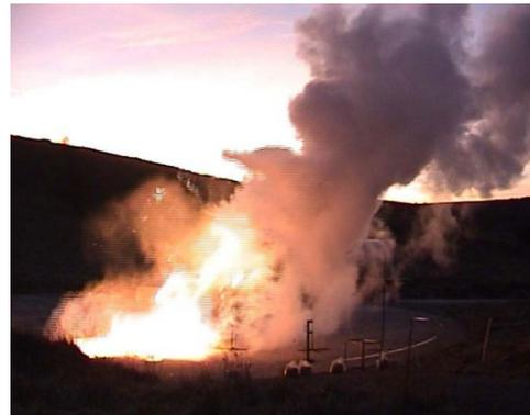
Abbildung 2. 2LH-Großauslösung und verzögerte Zündung (5 bar - 12 mm; Projekt PRESLHY - HSE).
