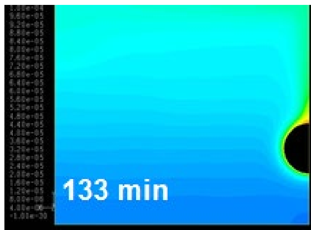
Obrázek 3. Snímek rozptylu prostupujícího vodíku v garážovém prostoru z odk. [13]
