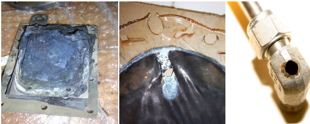
Figura 30. Parti danneggiate di elettrolizzatore PEM ad alta pressione.
