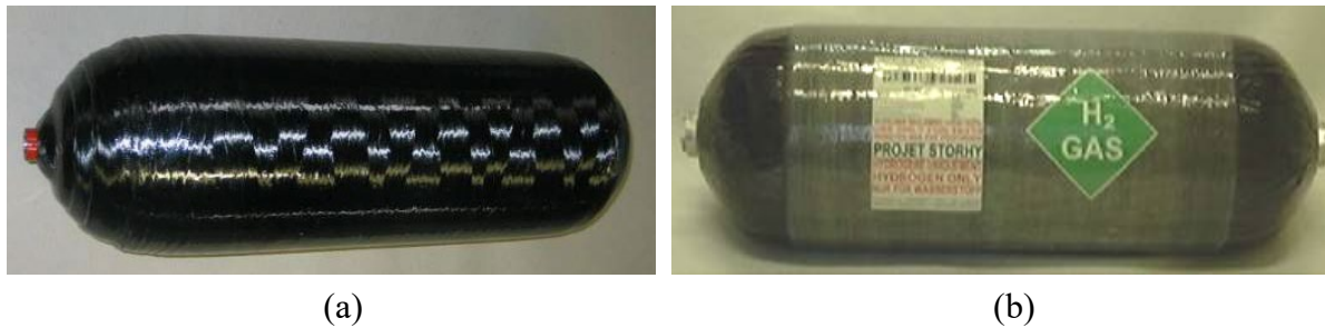
Figura 12. Prototipi di cilindri a 700 bar sviluppati e testati nell'ambito del progetto Europeo STORHY: (a) Tecnologia tipo III, (b) Tecnologia tipo IV.
