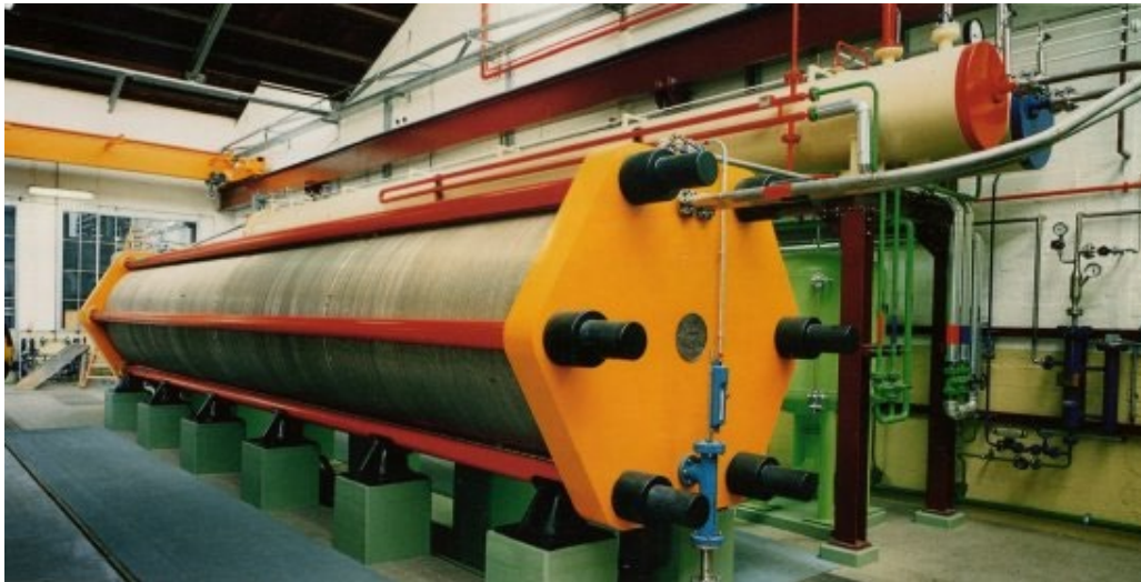
Figura 5. Elettrolizzatore alcalino, IHT tipo S-556, 760 m 3 /h e 30 bar [1]
