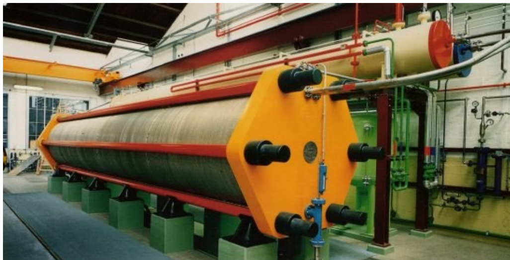
Obrázek 5. Alkalický elektrolyzátor, IHT typ S-556, 760 m 3 /h a 30 bar [1]
