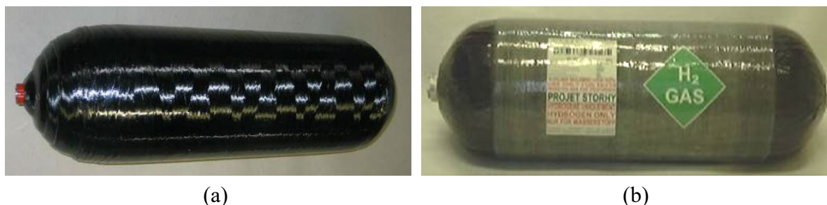
Obrázek 12. Prototypy lahví s tlakem 700 barů vyvinuté a testované v rámci evropského projektu STORHY: (a) technologie typu III, (b) technologie typu IV.
