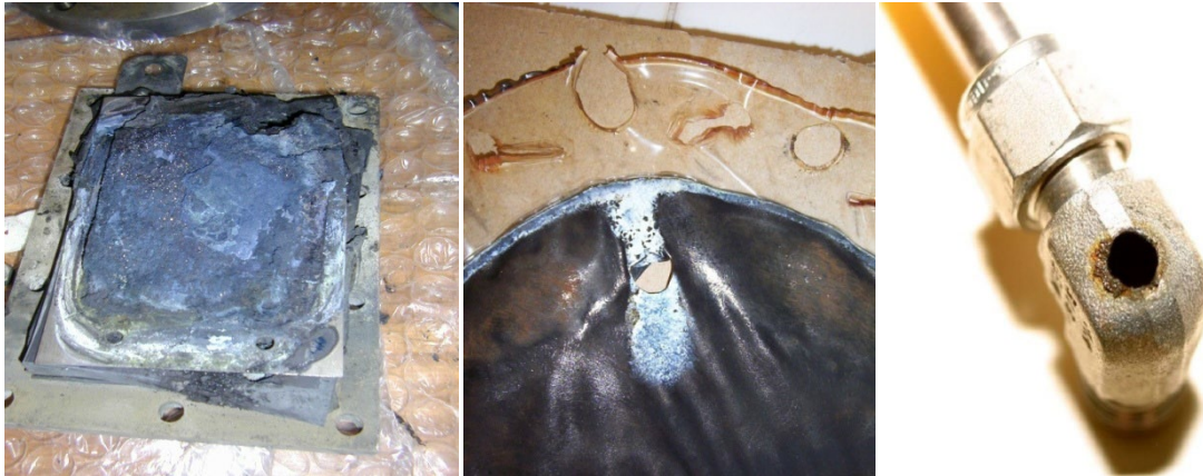
Abbildung 30. Beschädigte Teile eines Hochdruck-PEM-Elektrolyseurs.
