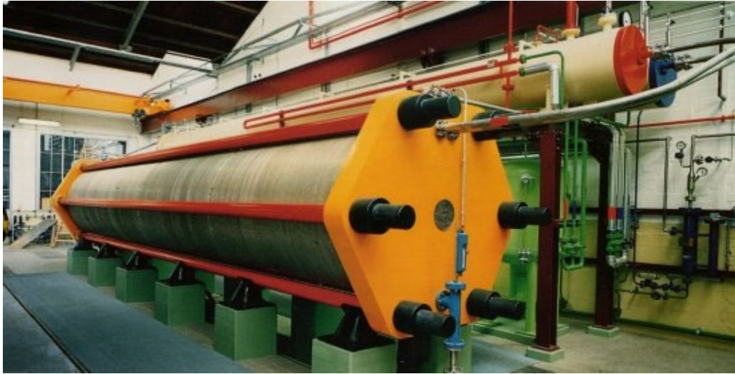
Abbildung 5. Alkalischer Elektrolyseur, IHT Typ S-556, 760 m 3 /h und 30 bar [1]
