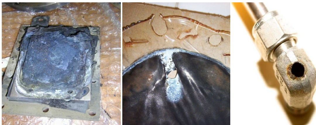
Figur 23. Skadde deler av høytrykks PEM-elektrolytator.
