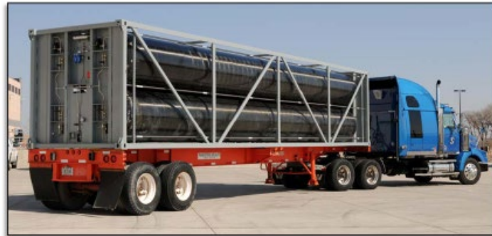
Figura 15. Trailer trasportante quattro contenitori composti sviluppati dalla Lincoln Composites.
