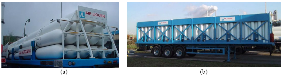
Figura 14. Due tipologie di trailer CGH 2 operati da AirLiquide in Europa: (a) trailer tubolari, trasporto da 2,000 a 3,000 Nm 3 di idrogeno e (b) trailer di cilindri compositi, trasporto di 6,200 Nm 3 di idrogeno.
