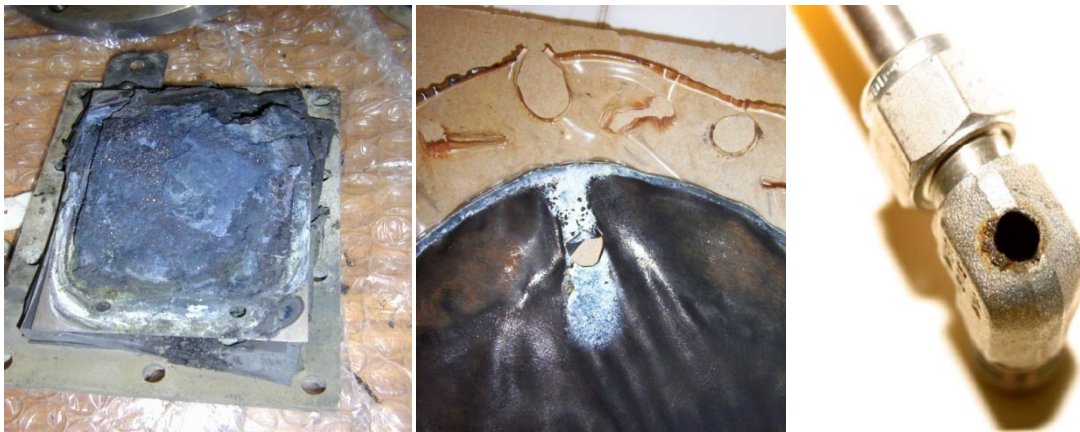
Figura 24. Parti danneggiate di elettrolizzatore PEM ad alta pressione.
