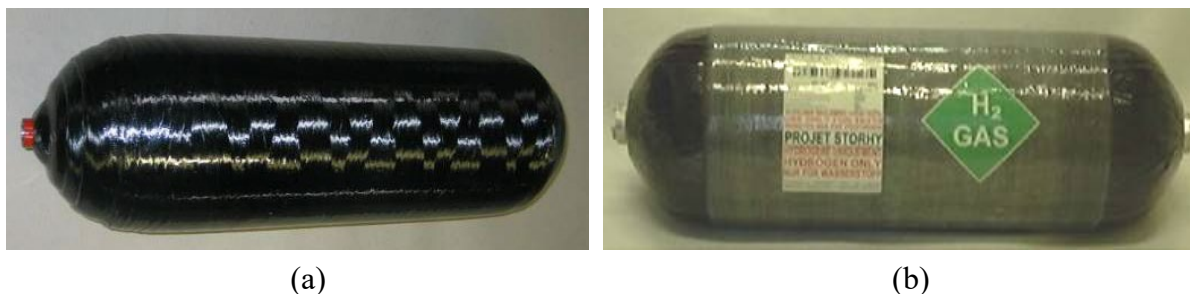
Figura 7. Prototipi di serbatoi a 700 bar sviluppati e testati nell'ambito del progetto Europeo STORHY: (a) Tecnologia tipo III, (b) Tecnologia tipo IV.
