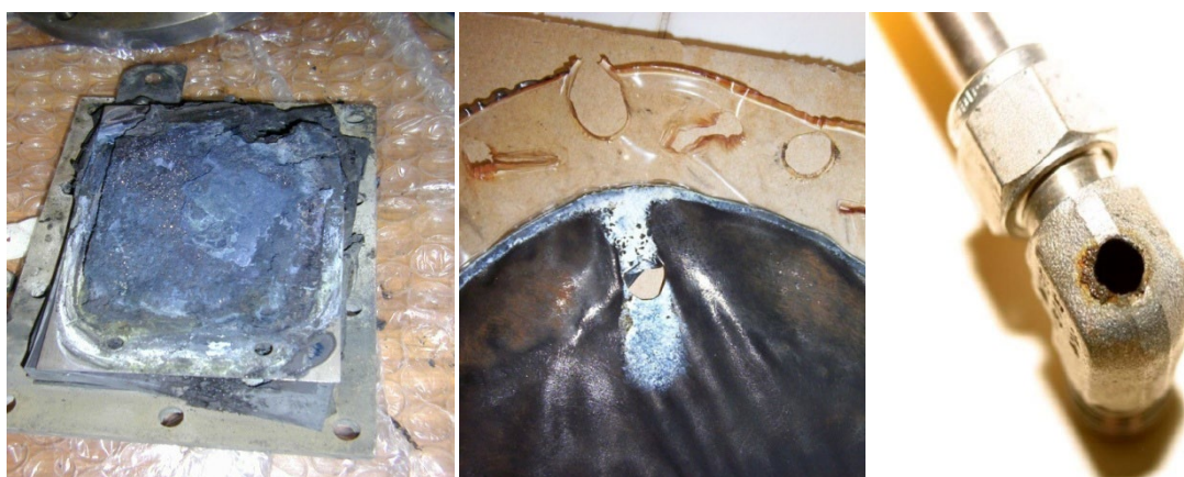
Obr. 23 Poškozené části vysokotlakého elektrolyzéry PEM.
