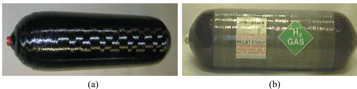
Obr. 6 Prototypy lahví s tlakem 700 barů vyvinuté a testované v rámci evropského projektu STORHY: (a) technologie typu III, (b) technologie typu IV.
