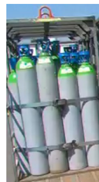
Abbildung 2. Bordspeicher für Wasserstoff (a), ein Flaschenbündel (b) und ein Korb mit Flaschen für den Transport (c).
