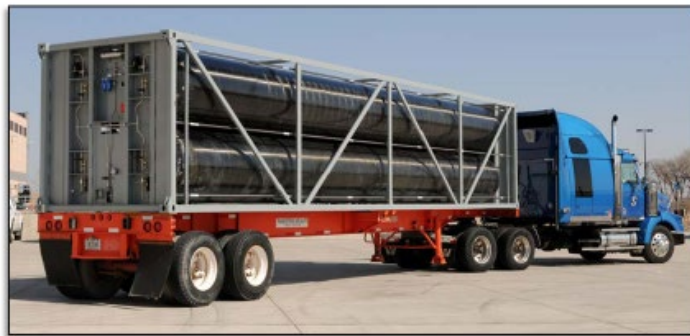
Abbildung 14. Ein Anhänger mit vier von Lincoln Composites entwickelten Verbundstofftanks.
