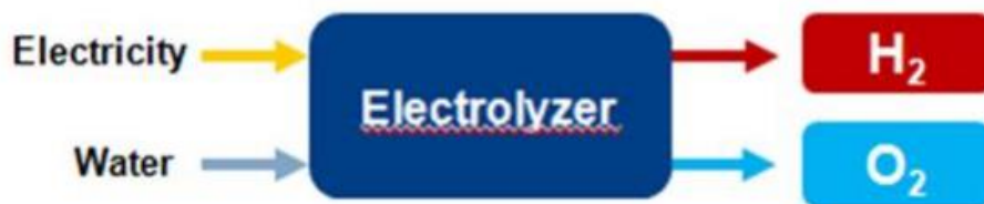
Figura 32. Principi del processo di elettrolisi.
