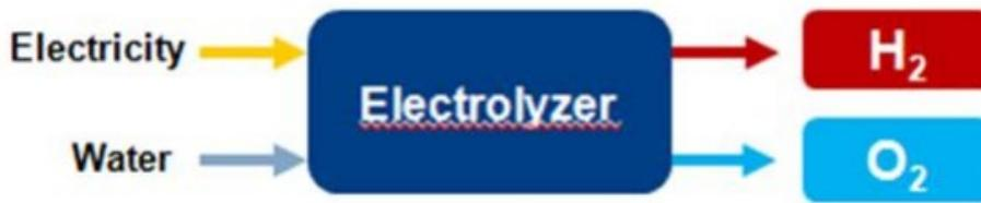
Abbildung 32. Prinzip des Elektrolyseprozesses.
