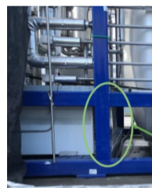
Obrázek 17. Ochrana proti nárazu (modře) ve spodní části.
