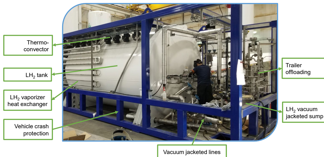
Obrázek 13. Přehled skříně LHRS – „kryogenní“ strana.
