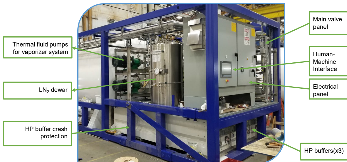
Obrázek 14. Přehled skříně LHRS – „teplá“ strana.
