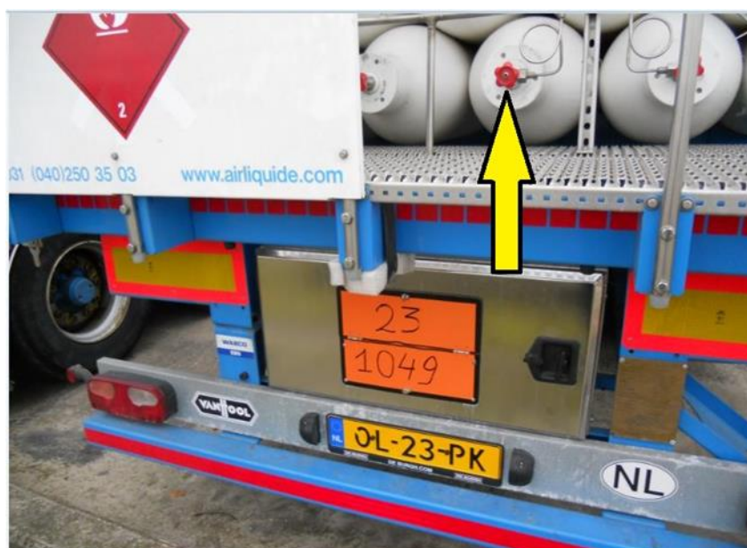
Figura 53: Valvola individuale del cilindro su un trailer H2. ©Air Liquide-2014
