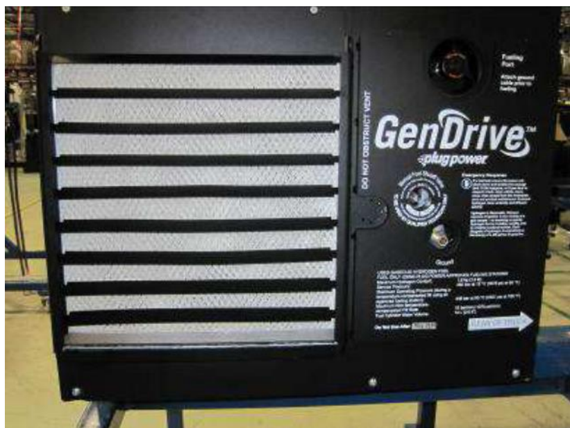
Figura 49: Sfiato di rilascio H2 di un carrello elevatore (su ciascun lato). ©Air Liquide-2014
