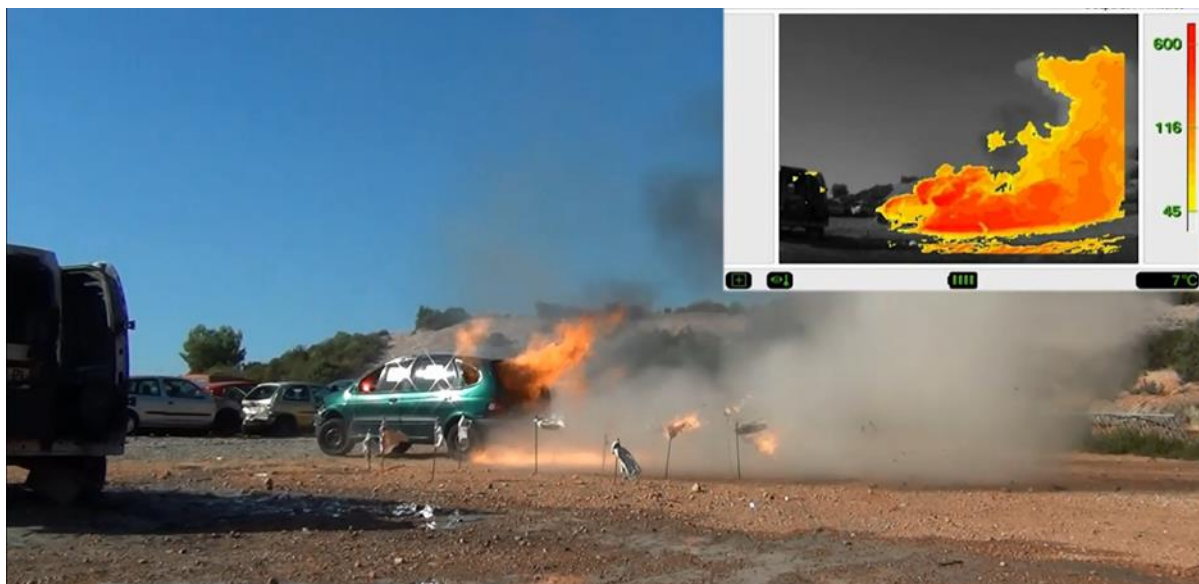
Figura 8: Incendio di un serbatoio H2 (700b) (ENSOSP 2014).
