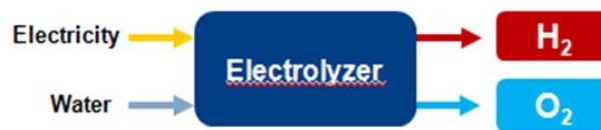
Figura 15: Principio di funzionamento di un elettrolizzatore.
