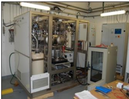
Figura 17: Specifiche tecniche e fotografia di uno stack PEMFC per l'accumulo di energia di AREVA.
