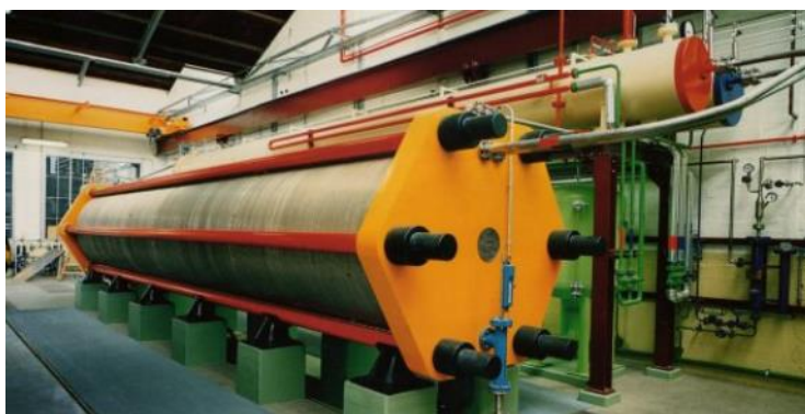
Figura 19: Elettrolizzatore alcalino IHT tipo S-556, 760 Nm 3 /h e 30 bars.
