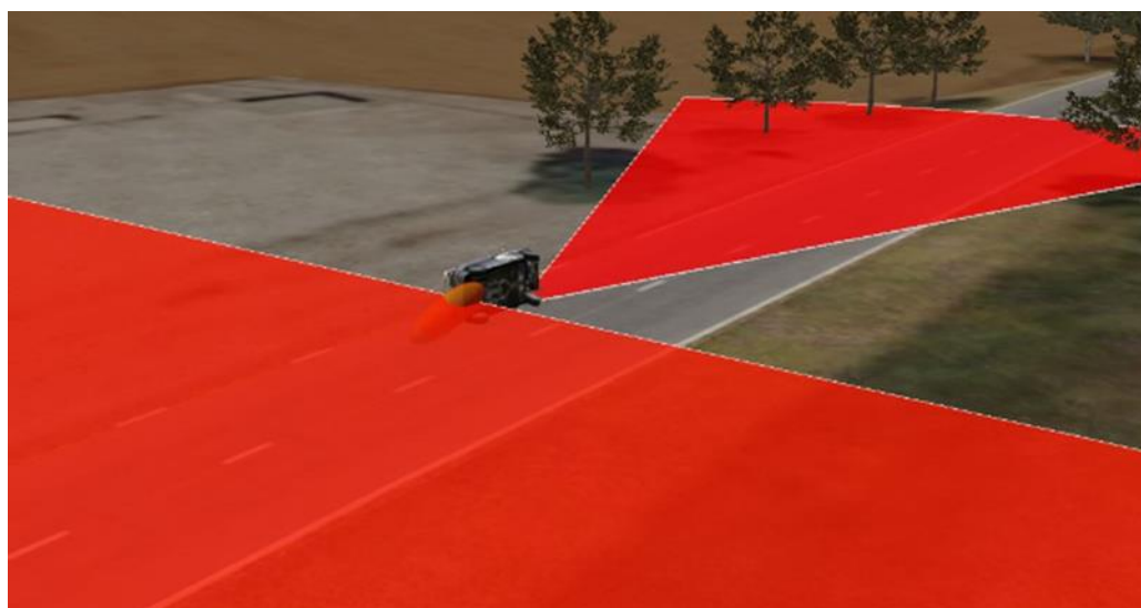
Obrázek 45: (Červeně) zakázané úhly pro přístup k vozidlu s palivovými články během požáru na boku (zařízení TPRD je umístěno mezi zadními koly pod úhlem 45°) ©crise-2015
