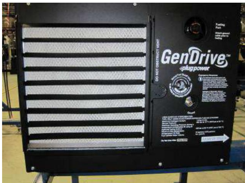
Obrázek 49. Vypouštěcí otvor H 2 na vysokozdvížném vozíku (na každé straně) ©Air Liquide-2014
