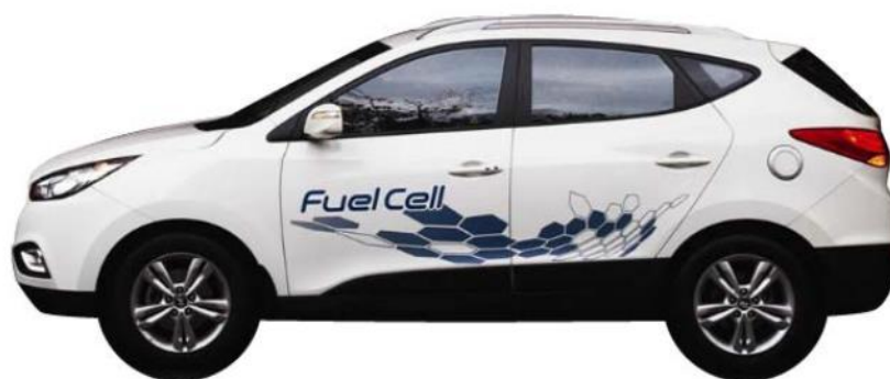
Obrázek 29: označení vozidla (průvodce nouzovým zásahem u vozidla Toyota Ix35)
