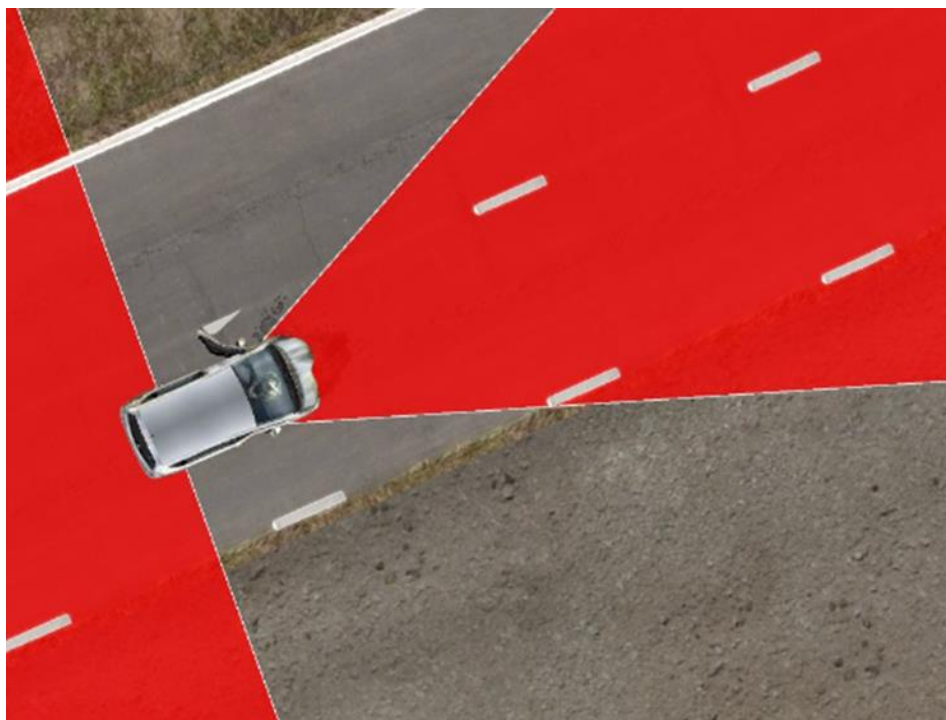
Obrázek 43: (červeně) zakázané úhly pro přístup k vozidlu s palivovými články během požáru na kolech. ©Crise-2015
