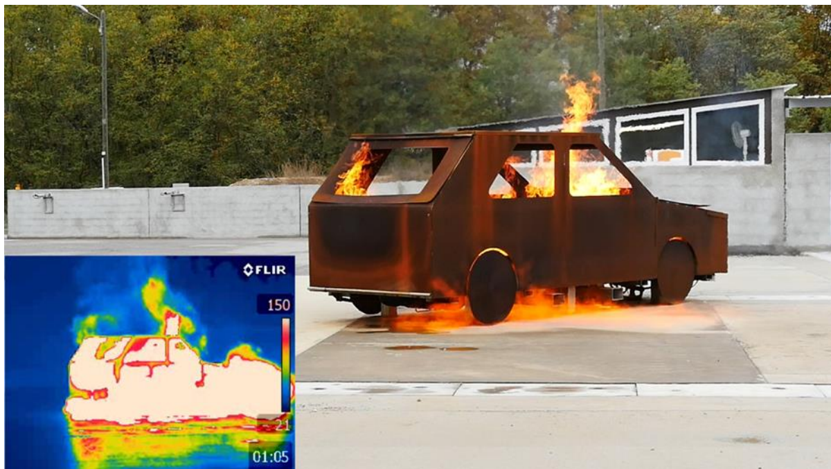
Obrázek 9: Vodíkový plamen pod maketou vozidla na H 2 (ENSOSP 2016)
