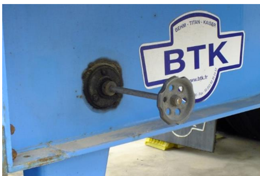
Obrázek 56 Hlavní ventil návěsu na H 2 (pohled zvenčí) © Areva/ENSOSP 2015
