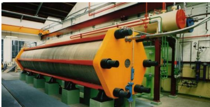
Obrázek 19: Alkalický elektrolyzér IHT typ S-556, 760 Nm 3 /h a 30 bar
