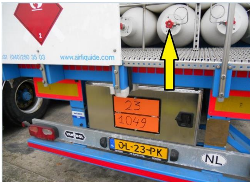
Obrázek 53: Samostatný ventil láhve na návěsu na H2. ©Air Liquide-2014
