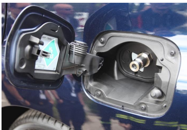
Obrázek 26: Plnicí otvor vozidla Toyota Mirai.
