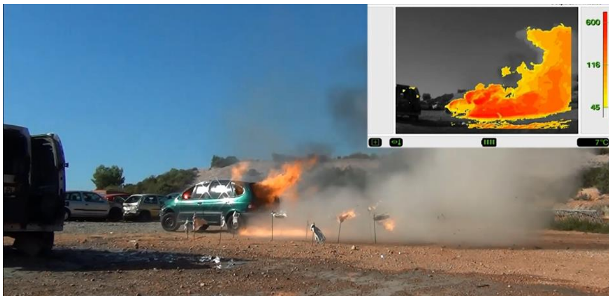
Obrázek 8: Požár cisterny s H 2 (700 bar) (ENSOSP 2014).
