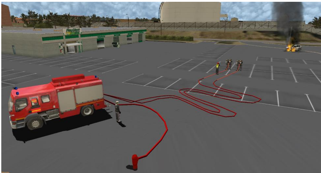
Obrázek 42: Připravenost k přímému požárnímu útoku (připojení k hydrantu, pokud je k dispozici)
