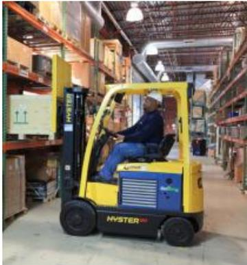
Chariot élévateur à fourche à pile à combustible
