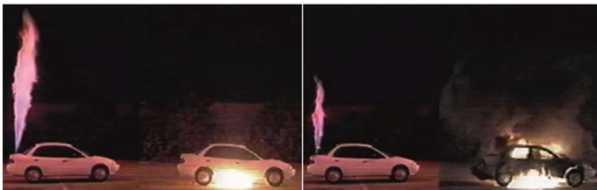
Figuur 3. Fakkelflam van waterstof en brand van benzine: 3 s (links) en 60 s (rechts) na aanvang van een autobrand [13].
