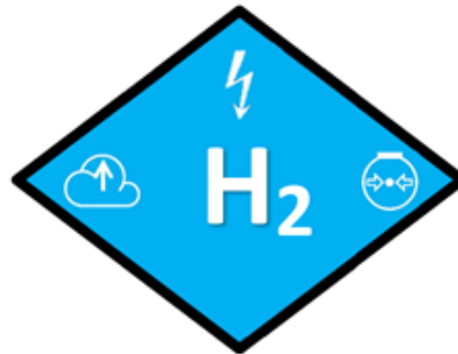
Figuur 4. Een symbool ontwikkeld door CTIF voor een brandstofcelvoertuig op gecomprimeerde gasvormige waterstof [15]
