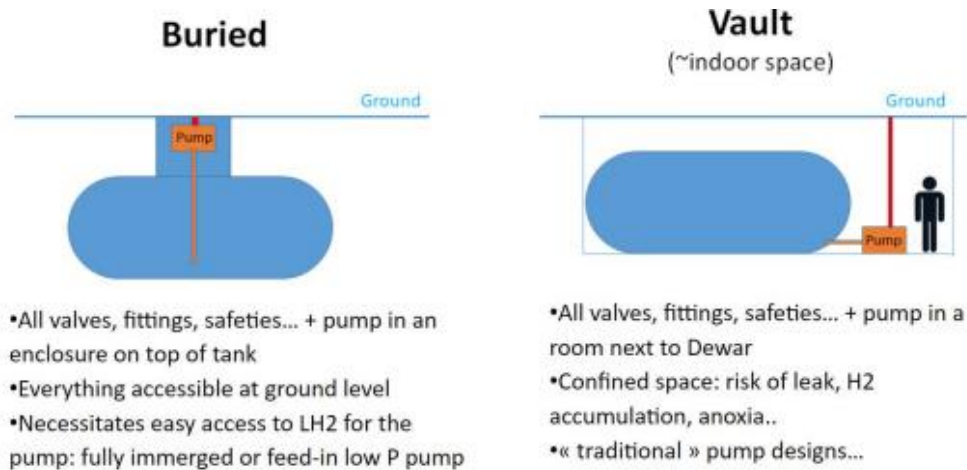
Figuur 4. De twee voornaamste ontwerpen voor ondergrondse opslagsystemen voor LH 2 .
