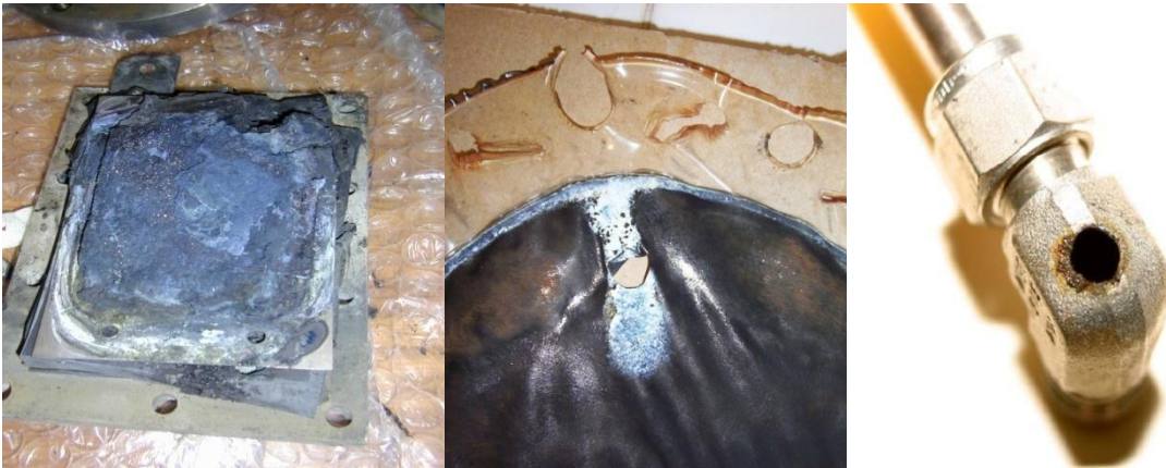
Figuur 23. Beschadigde delen van een PEM-elektrolyser onder hoge druk.
