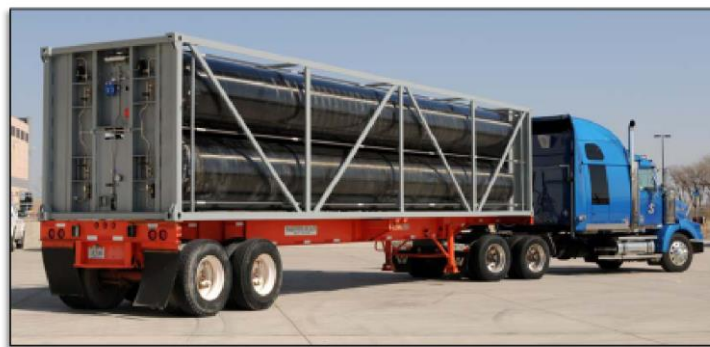
Figuur 16. Een oplegger met vier composiettanks, ontwikkeld door Lincoln Composites.
