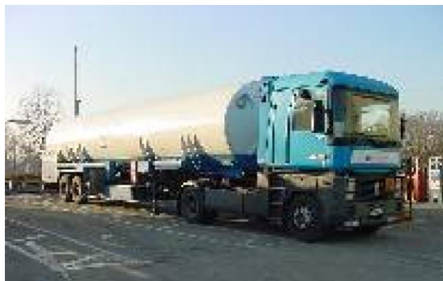
Figuur 17. Een door Air Liquide gebruikte tankwagen voor het vervoer van \text{LH}_2 naar de eindgebruiker.
