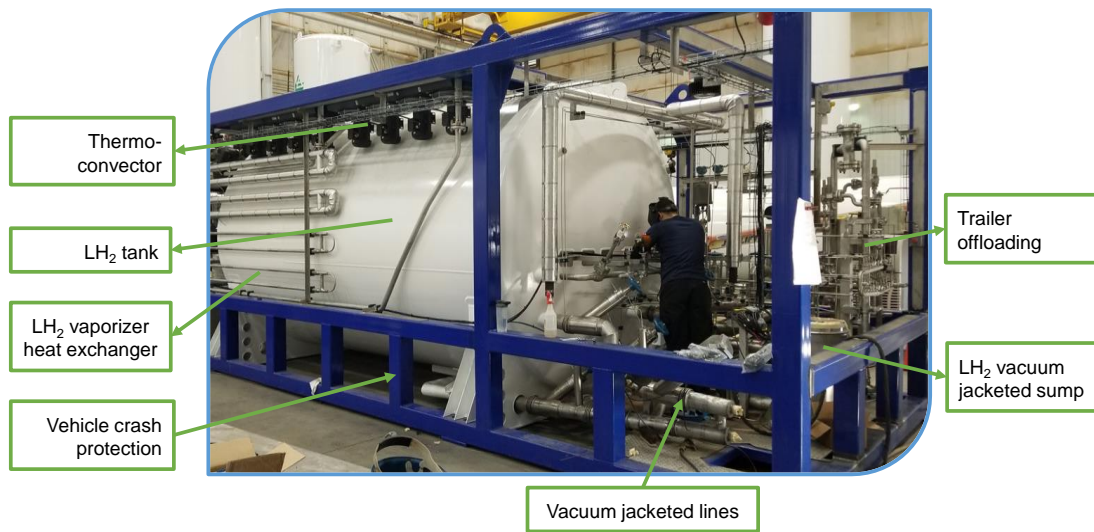
Figuur 13. Overzicht inbouwkast tankstation vloeibare waterstof – "cryogene" kant.
